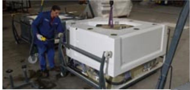
Die Vollverkleidung ist in einem Stück aus hochwertigem Mehrschicht-Polyesterlaminat im Handauflege-Verfahren gefertigt.
