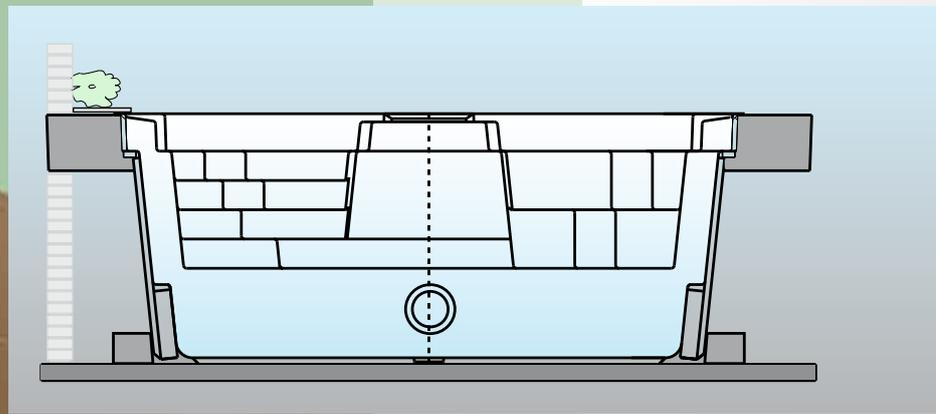
Einbau freitragend mit Überlaufrinne: Wandverstreben aus Stahl.
