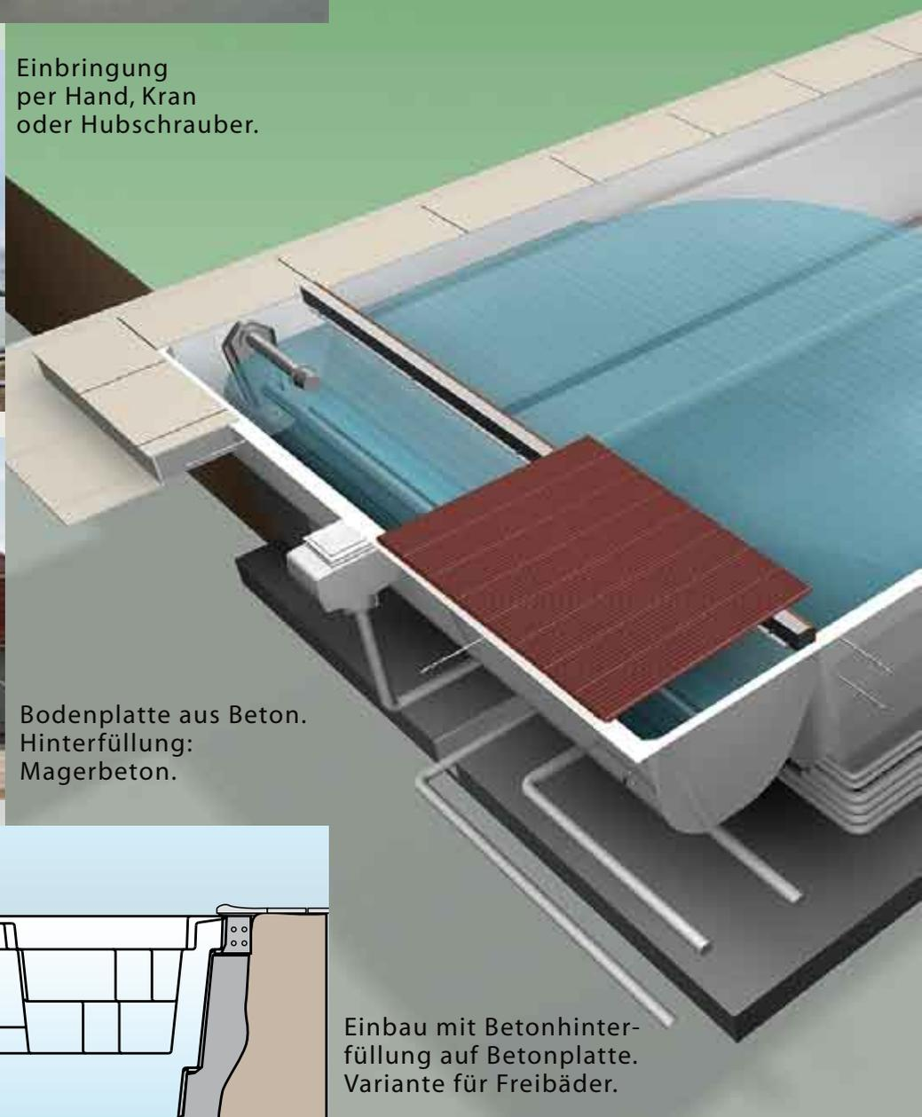
Einbau mit Betonhinterfüllung auf Betonplatte.
